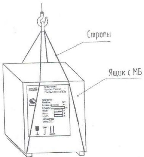
Рис.8 Схема строёвки мотоблока при грузоподъёмных
